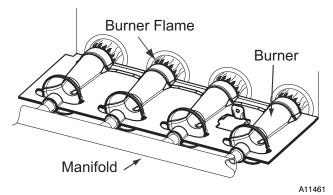
Fig. 17 - Burner Flame
